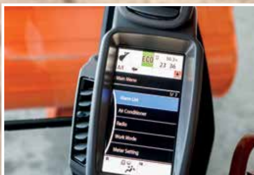
De LCD-monitor toont de status en de instellingen van de machine.
