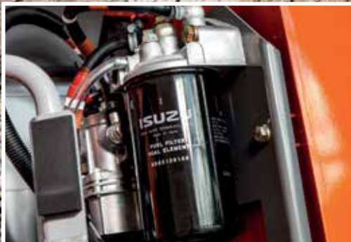
Vervanging van het brandstofhoofdfilter is gemakkelijker geworden.
