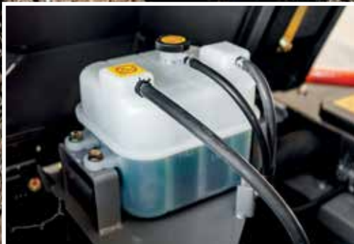
De expansietank voorkomt oververhitting van motoronderdelen.
